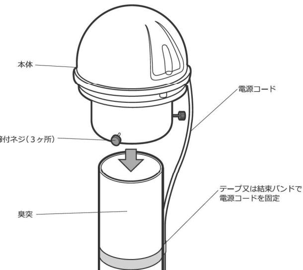
注)一部の塩化ビニール管に取り付ける際、付属のゴムキャップを使用せず、締付ネジのみで固定する場合がございます。
