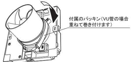
3. 電源線の接続・本体の上下を確認し、パイプに挿入します。本体を付属のタッピングねじ2本で確実に固定してください。
