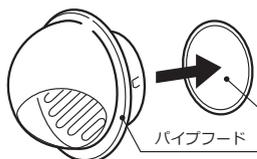
※特に薄壁の場合、パイプフード(ベントキャップ)が、パイプ用ファン本体にあたらぬよう施工してください。
