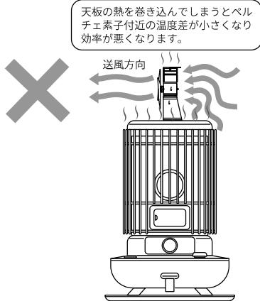
図のように天板の端に設置した場合は、ストーブの熱で温められない空気を引き寄せるので、冷却フィンが冷却され温度差が大きくなり、ファンの回転も速くなります。
