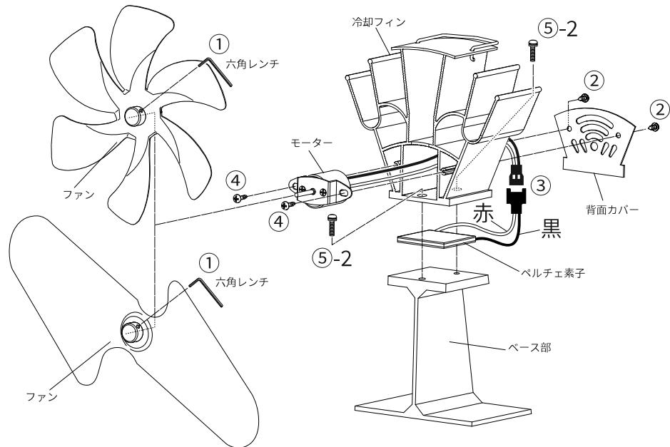
① ファン中央のネジを六角レンチでゆるめてモーター軸からファンを取りはずしてください。(六角レンチ 2mm)
